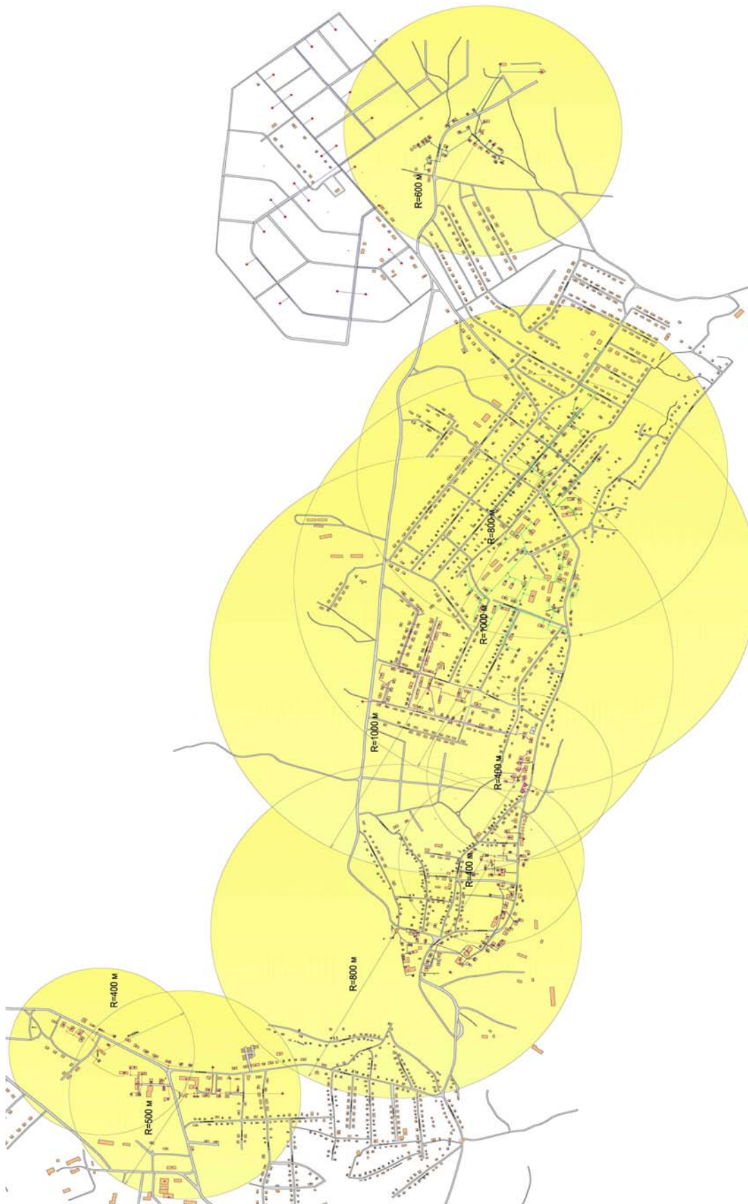
Рисунок 4.1 - Зоны СЦТ и индивидуального теплоснабжения поселка Мотыгино.
